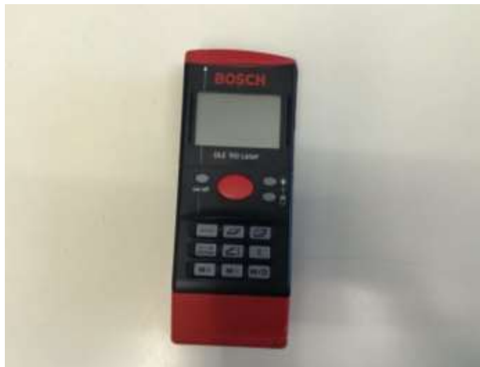
Slika 23: Laserski merilnik boksa (Detmar, 5. 2. 2020)
