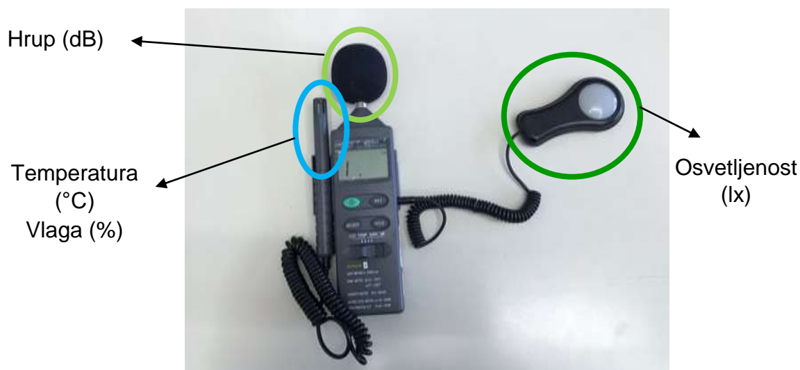
Slika 15: Naprava za merjenje hrupa, temperature, osvetljenosti in vlage (Detmar, 5. 2. 2020)
