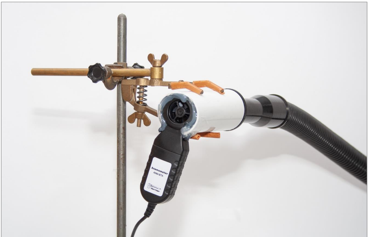
Slika 4: Merjenje hitrosti zraka skozi cev
