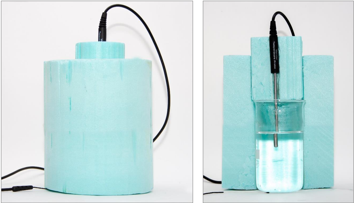
Slika 6: Merilna posoda s temperaturnimi tipali (levo sestavljena posoda, desno prerez posode)
