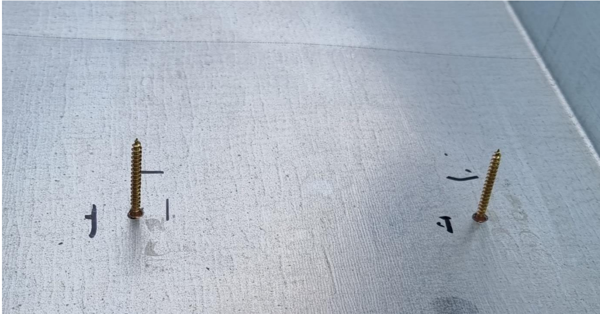
Slika 37 Simulacija globokega temeljenja
