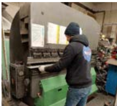
Slika 32: Upogibanje pločevine (Lasten vir)
