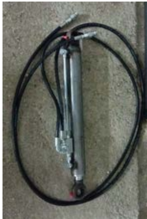
Slika 35: Praktični prikaz prve sheme – hidravlika za priklopni del
