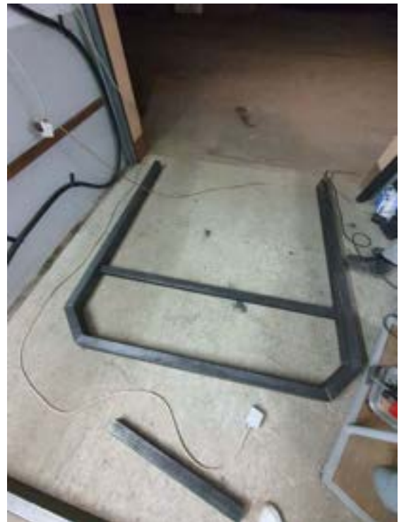
Slika 20: Eden izmed šestih okvirjev, ki se bodo privarjeni na osnovni okvir (Lasten vir)
