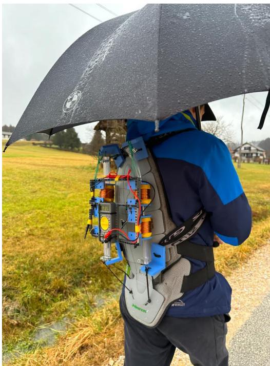
Slika 10: Prikaz testiranja SOS-nahrbtnika s hojo
