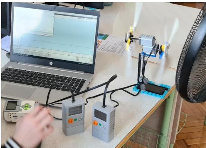
Slika 40: Poskus posodobljene rešitve z razširjenimi lopaticami.
